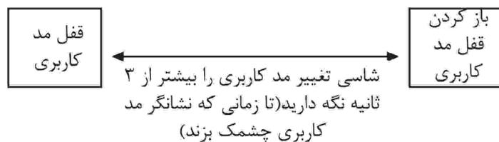
\* اگر شما شاسی تغییر مد کاربری را در وضعیت قفل کاربری کمتر از ۳ ثانیه فشار دهید، نشانگر مد کاربری (LED سبز) ۳ بار چشمک می زند.
