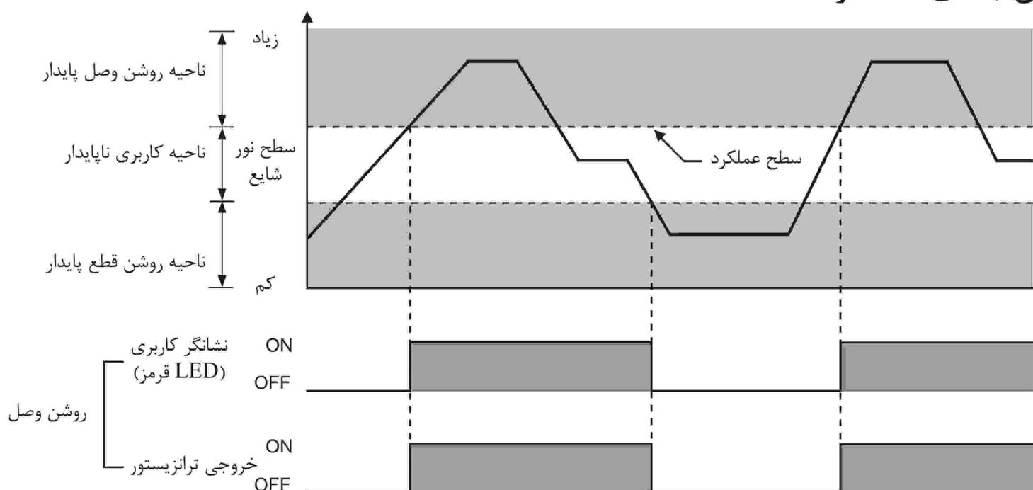
\* شکل موج های نشانگر کاربری و خروجی ترانزیستور برای حالت کاربری روشن وصل هستند. این شکل موج ها بر عکس حالت کاربری تاریک وصل هستند.
